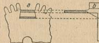
Fig. 25. Repararea dinților la casetă
