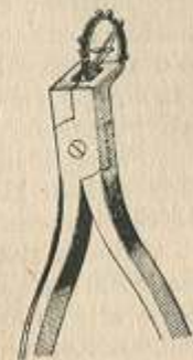
Fig. 62. Sculă pentru îndreptarea balansierului
