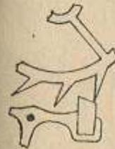
Fig. 84. Roata ancorei cu dinți ascuțiți
