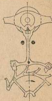
Fig. 97. Poziția de echilibru a balansierului
