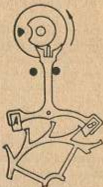
Fig. 99. Devierea balansierului (amplitudinea) de 270°
